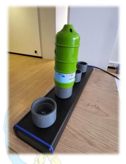
Les balises ont une autonomie de 1 mois sans recharge. Un chargeur dédié permet de recharger simultanément 4 balises en 4 heures. Alimentation en 230 VAC.
